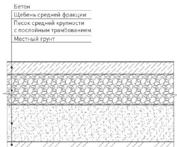
Рисунок 17. Схема устройства основания под бетон.
